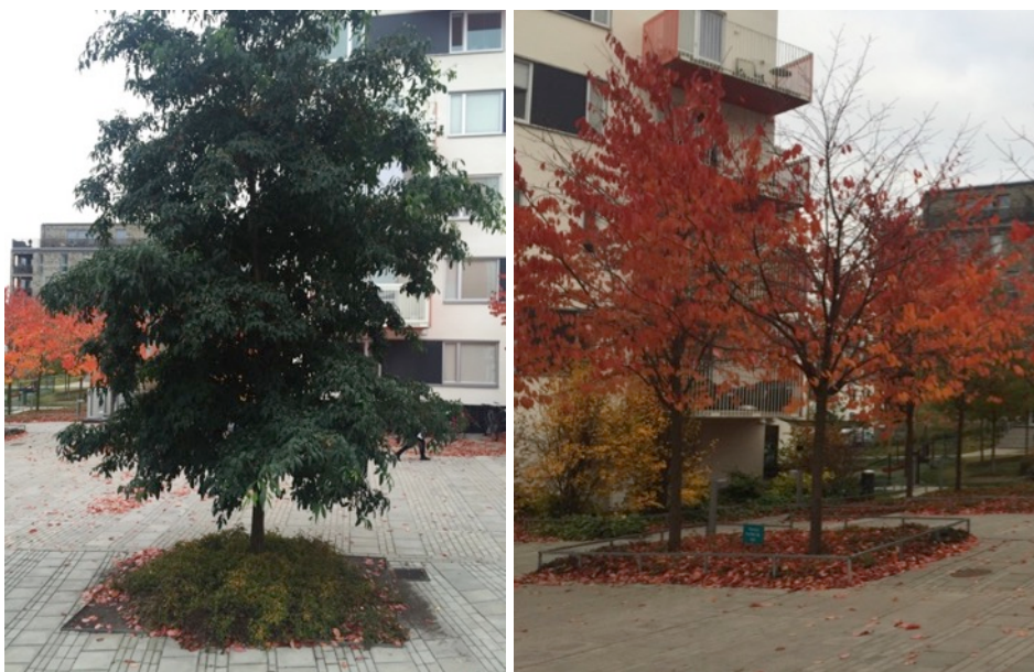
Figur 15, två exempel på ytor med högre genomsläpplighet precis runt träd. Ytan under trädet skulle kunna byggas upp som en västbädd/dagvattenbiofilter. Foto Geoveta.
