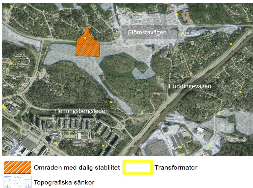
Figur 5. Exempel på transformatorstationer i riskområden för översvämning samt ras och skred.
