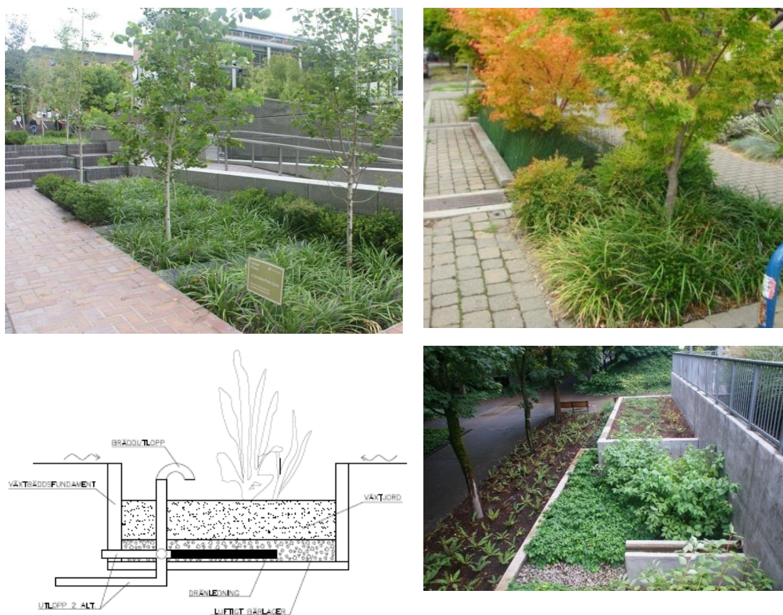
Figur 8. Exempel på utformning av växtbädd. I nedre bilden till vänster syns en växtbädd i genomskärning där man även ser fördröjningsdelen ovan växtjorden.
