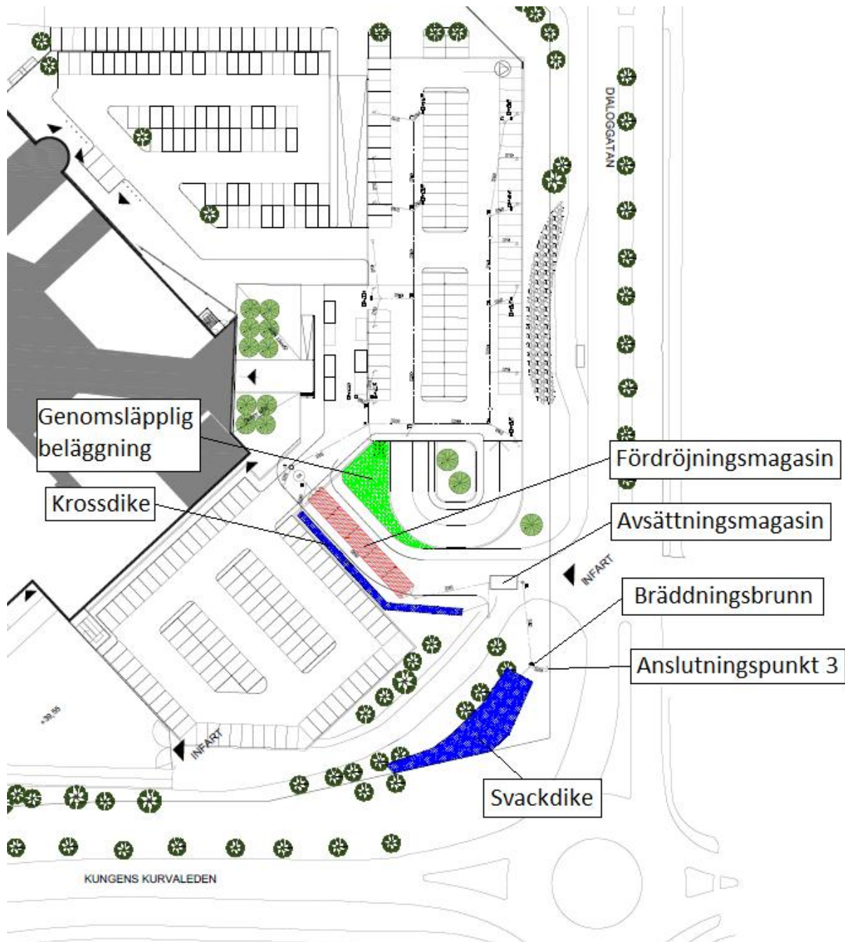
Figur 8. Utredningsskiss, Novamark. OBS! Skissen är schematisk och ger inga exakta ytor eller lösningar för dagvattenhantering, utan visar exempel på föreslagna lösningar samt eventuell placering av dessa.
