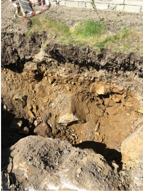
Bild 5: Jordlagerföljden för provgrop A5
