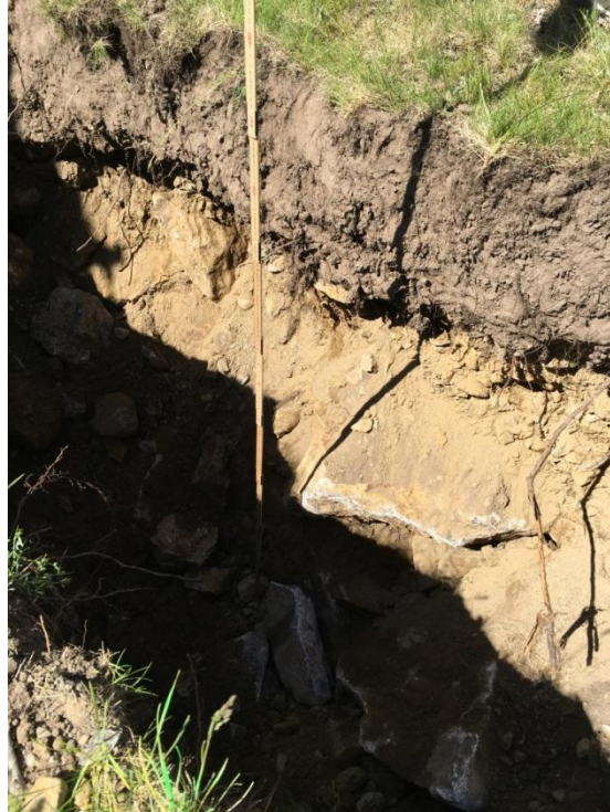
Bild 4: Jordlagerföljden för provgrop A4
