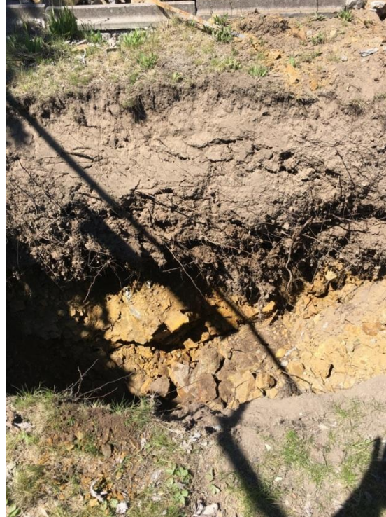
Bild 2: Jordlagerföljden för provgrop A2
