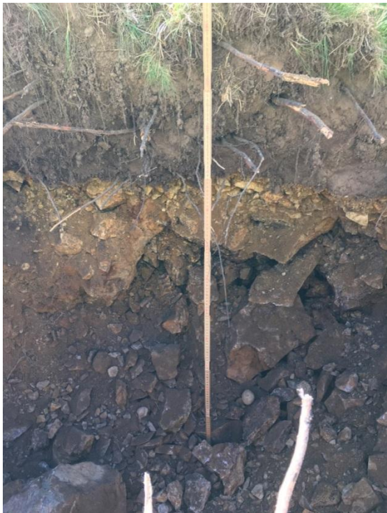
Bild 3: Jordlagerföljden för provgrop A3
